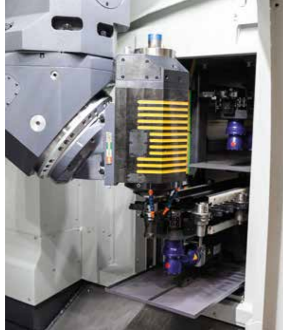
Automatic tool changer Cambio utensili automatico Automatischer Werkzeugwechsler Changeur automatique d'outils
